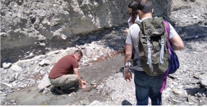
Şəkil 19. Zarat Xeybəri çayında suyun sərfinin həcm üsulu ilə ölçülməsi, (18.06.2023).
